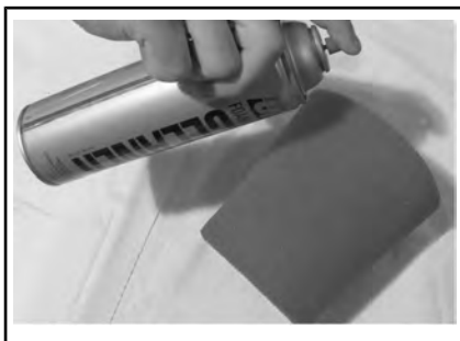
ТИПОВОЙ ВАРИАНТ – НАНЕСЕНИЕ МАСЛА НА ПОРОЛОНОВЫЙ ФИЛЬТР
