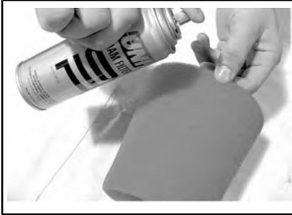
ТИПОВОЙ ВАРИАНТ - НАНЕСЕНИЕ МАСЛА НА ПОРОЛОНОВЫЙ ФИЛЬТР
