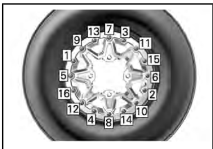
ТИПОВОЙ ВАРИАНТ - ПОРЯДОК ЗАТЯЖКИ ВИНТОВ
