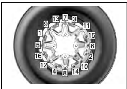
ТИПОВОЙ ВАРИАНТ - ПОРЯДОК ЗАТЯЖКИ ВИНТОВ
