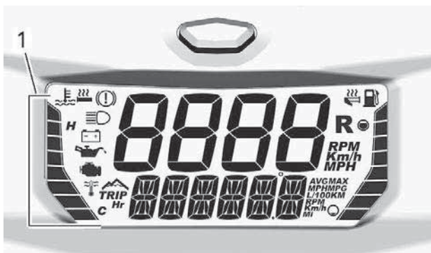
1. Левый указатель панели приборов
