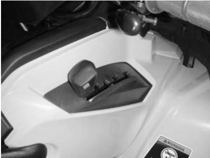
РАСПОЛОЖЕНИЕ РЫЧАГА ПЕРЕКЛЮЧЕНИЯ ПЕРЕДАЧ
